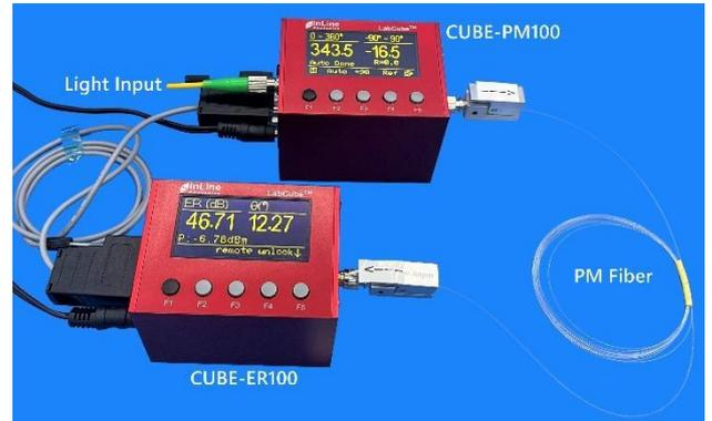
CUBE-ER100 是一种基于旋转偏振片的高性能偏振消光比测试计，可用于光纤产品和自由空间光检测。CUBE-ER100 的消光比测量动态范围高达 52dB，角度分辨率为 0.03°，工作波长为 600nm~1600nm。
