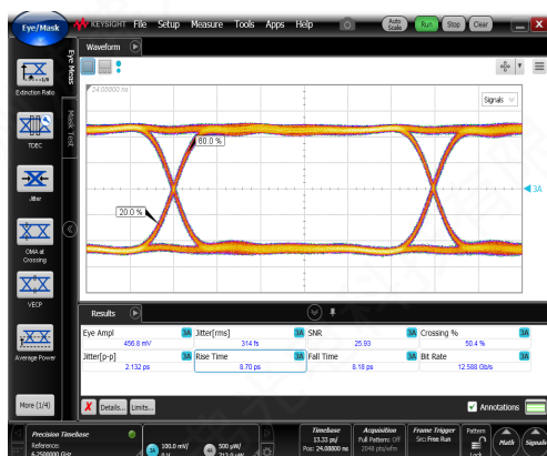
Input signal Eye amplitude = 0.45\text{ V}_{pp}
